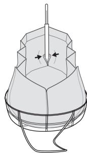
5. Klettverschluss schließen und Wasserstandsanzeiger fixieren / Close the hook- and loop fastener and fix the water level indicator in place
