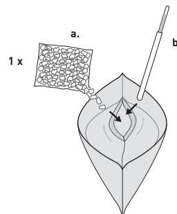
1. Klettverschluss im Drainagevlies öffnen / Open the hook- and loop fastener in the drainage felt
