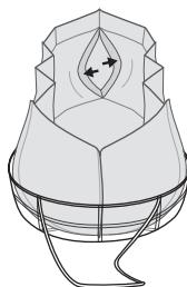
3. Klettverschluss im Drainagevlies öffnen / Open the hook- and loop fastener in the drainage felt
