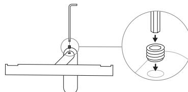
1. Wandbefestigung an der Wand anbringen / Fasten the wall fitting to the wall
