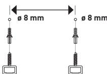
1. Deckenabhängung in Decke befestigen / Fasten hook in ceiling
